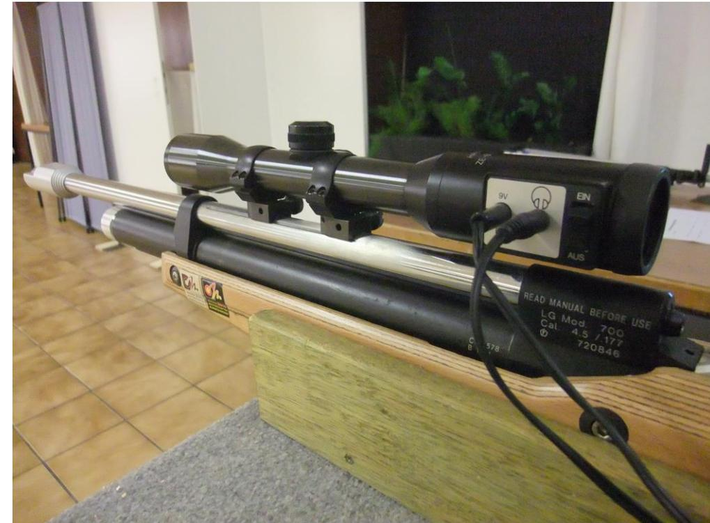
*Zielfernrohr mit Kopfhöreranschlüsse*
